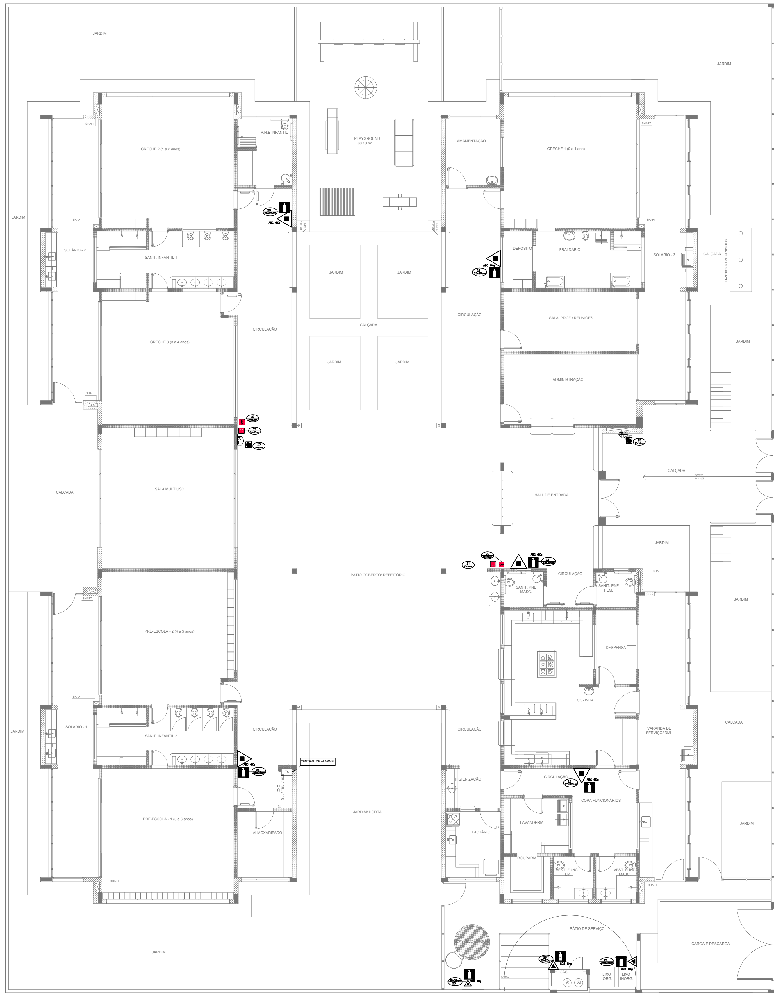
5 PLANTA BAIXA - LOCAÇÃO DOS EXTINTORES ESCALA 1/100
